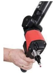
Эта облегченная система с лазерным сканером поставляется в виде недорогого модуля. Не применяется дополнительный кабель или контроллер между лазерным сканером и портативной измерительной рукой, что обеспечивает возможность неограниченного вращения Абсолютной руки ROMER относительно основной оси перемещения. Вследствие совершенной сбалансированности Абсолютной руки ROMER со встроенным сканером обеспечивается возможность выполнения работ одной рукой.
