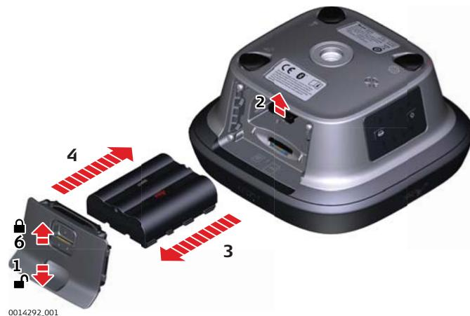
1. Переведите фиксатор батарейного отсека в направлении стрелки с символом открытого замка.
