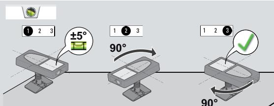
Дважды поверните прибор по направлению движения часовой стрелки на  $90^\circ$ . Следуйте инструкциям на дисплее. Выравнивание завершено после появления иконки "OK" на дисплее.
