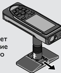
**i** Не перемещать и не наклонять Smartbase в процессе измерения.
