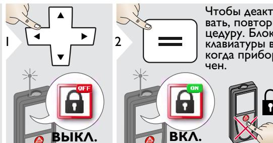
Чтобы деактивировать, повторите процедуру. Блокировка клавиатуры включена, когда прибор выключен.
