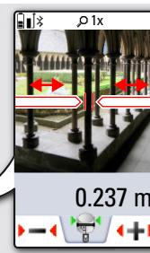
Выбрать стрелки с помощью курсорных клавиш, или нажав на сенсорный экран, и выберите нужные значения с помощью сенсорных клавиш. Расчитан соответствующий диаметр.
